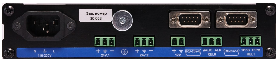
Рис.6.2. Задняя панель сервера Метроном-PTP-1U-V2 hw6.2.
